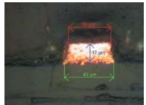
Ätzfaktor in Abhängigkeit von der Lage: links ein Leiterzug im „Leiterbündel“ auf der Leiterplattenoberseite und rechts ein Leiterzug in exponierter Lage
