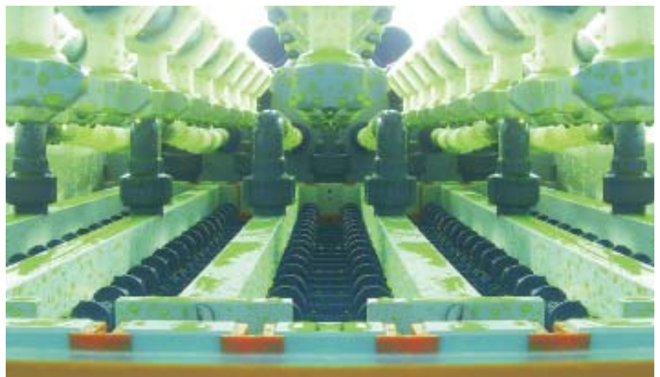
Blick in die Ätzkammer: oben Düsenstöcke, unten Absaugeinheiten zwischen den Transportrollen
