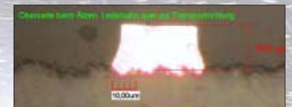
Geringe Unterätzung und hohe Ätzfaktoren nach dem Ätzen. Small undercuts and high etch factors after etching.
