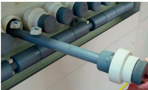
Praktikable Wartung: ausgebautes Düsenrohr einer Vakuum-Ätz-Anlage
