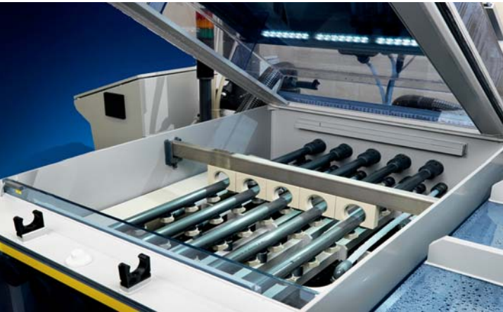
Ätzprozesse mit unterschiedlichen Chemikalien – hier der Blick in eine alkalische Vakuum-Ätz-Anlage
