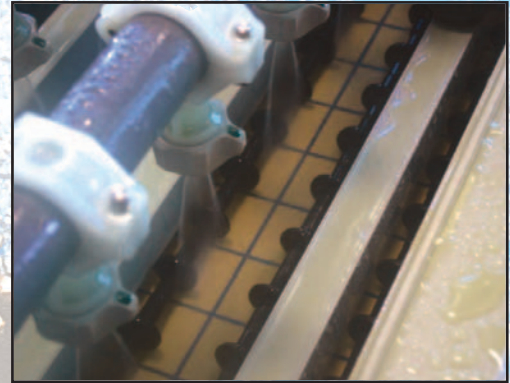
Sprühätzen mit Absaugung Spray etching with extraction
