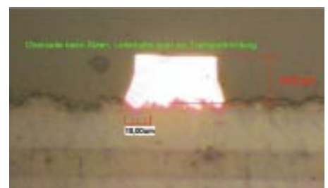
Hohe Ätzqualität - ohne Nachbearbeitung auch bei dünnsten Innenlagen
